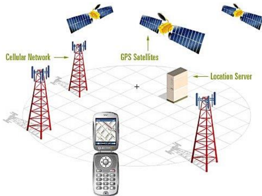
Figura 35: Architettura per il calcolo della Posizione
